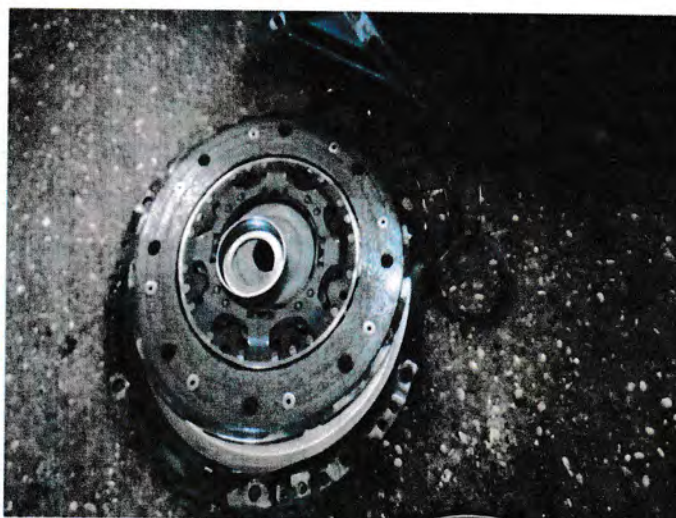
4. FORD S – MAX – Uništeno kvačilo
